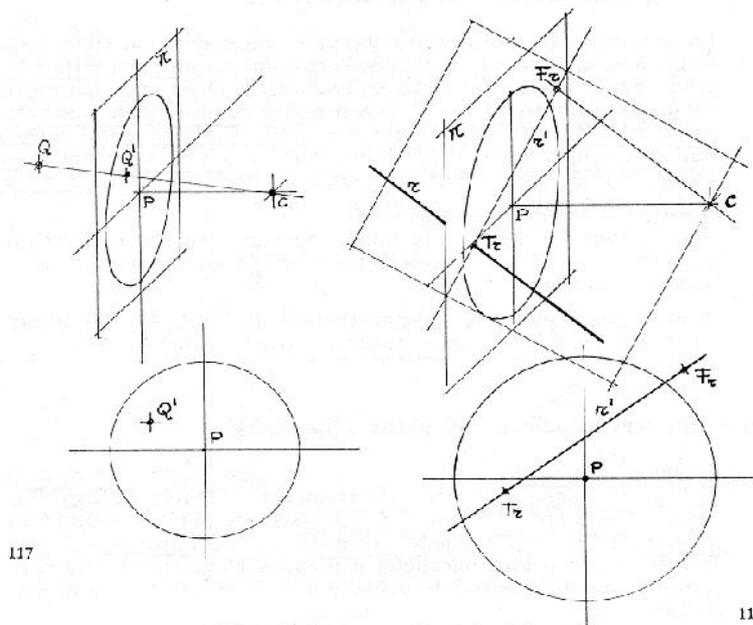
Le rette parallele al quadro  $\pi$  hanno la traccia e la fuga coincidenti con il punto improprio.
