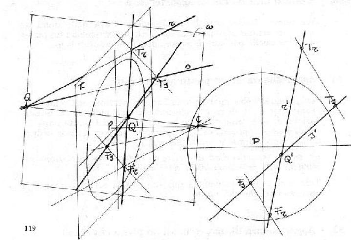
Assegnato un piano  $\alpha$  generico, chiameremo  $t_\alpha$ , traccia di  $\alpha$ , la retta intersezione di  $\alpha$  con  $\pi$ ;  $f_\alpha$  chiameremo invece la fuga di  $\alpha$ , retta intersezione di  $\pi$  con il piano passante per C e parallelo a  $\alpha$ ;  $f_\alpha$  rappresenta l'immagine su  $\pi$  della retta impropria di  $\alpha$ .
