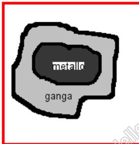
Figura 2 - Quando invece il metallo che si forma dalla riduzione del minerale è occluso nella ganga, la fusione del metallo non porta ad alcuna separazione in quanto esso rimane comunque intrappolato all'interno della matrice sterile.
